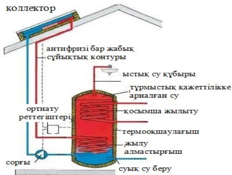
Сурет1 – Жеке үйдегі күн коллекторы арқылы суды жылыту сызбасы
