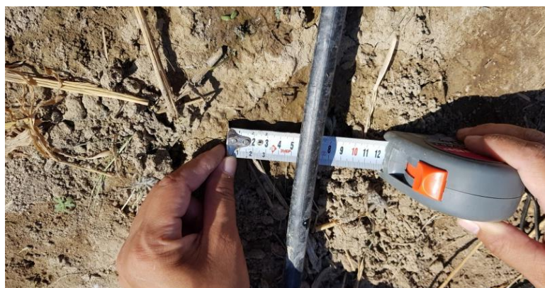
5-Сурет – Бір тамшылатқыштың ылғалдау аймағын өлшеу
