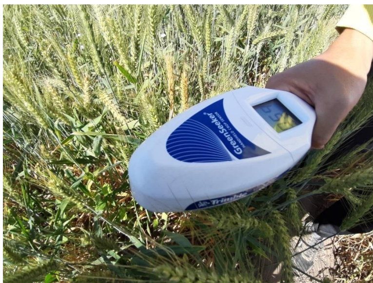
3-сурет – GreenSeeker құралымен күздік бидайдың NDVI-индексін анықтау
