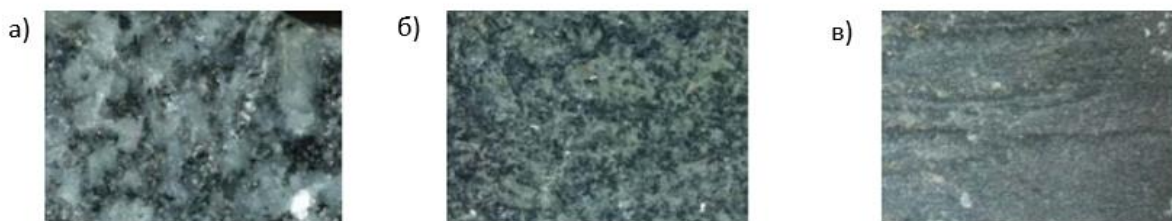
Рисунок 9 – Структура каменных заполнителей: а) гранит; б) габбро-диабаз; в) пироксеновый порфирит
