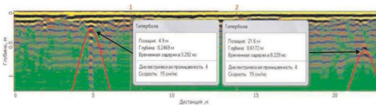
Рисунок 4 – Определение диэлектрической проницаемости асфальтобетонного покрытия
