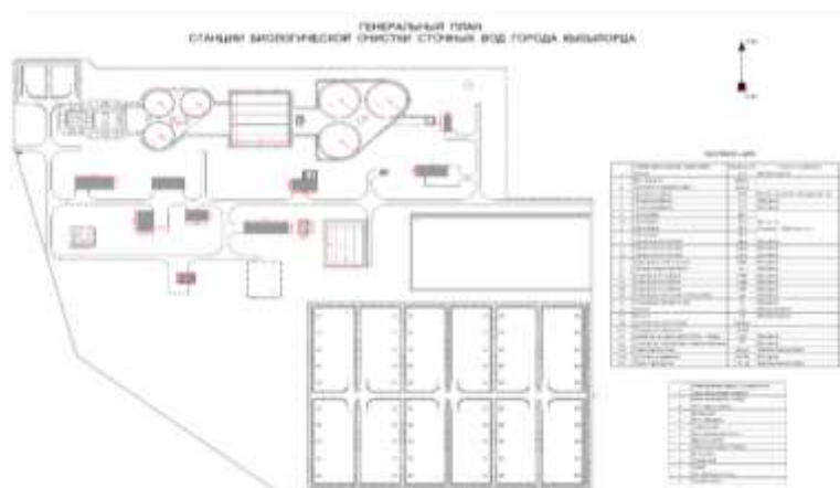
Рисунок 2. Генеральный план станции биологической очистки сточных вод города Кызылорда.
